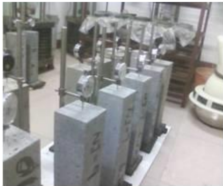
接触法测干燥收缩
