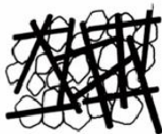
新型混凝土 (Densit) 砂、石 (骨料) 0~2%体积纤维 或4~10%体积纤维
